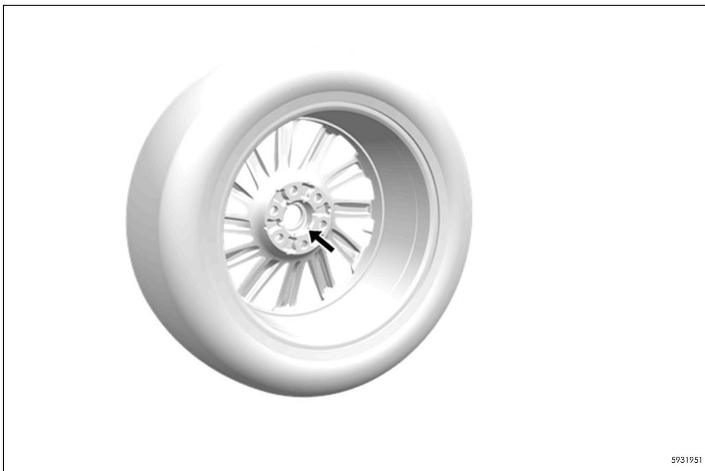
1. 在轮毂导向孔（如箭头所示）与轮毂法兰接触区域的内径上涂抹少量润滑剂。参见粘合剂、油液、润滑剂和密封胶
